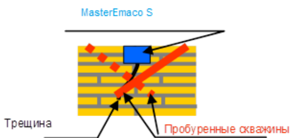
Рисунок 1 Примерная технология инъекции трещин.
