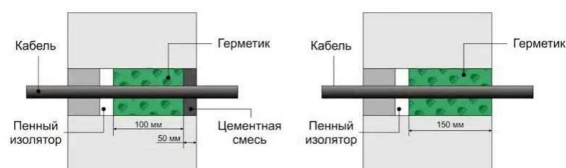
ВАРИАНТЫ ЗАПОЛНЕНИЯ ГЕРМЕТИКОМ ВВОДА
